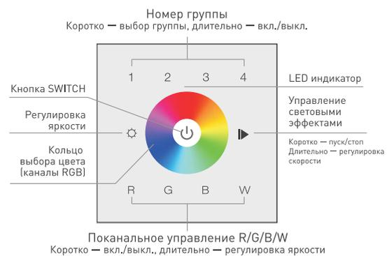
**Модуль управления светодиодными лентами Arlight Intelligent**
