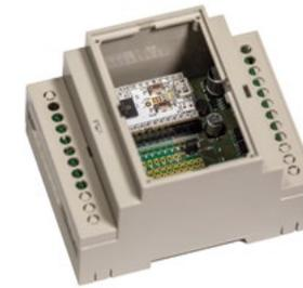
**Многофункциональное устройство Z-Uno Shield, основанное на плате Z-Uno**
