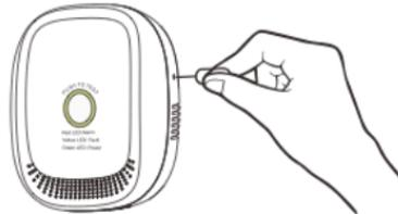
При помощи скрепки нажмите кнопку Z-Wave сети на 10 секунд. Устройство сбросится на заводские настройки и отправит контроллеру отчет Device Reset Locally Notification. В дальнейшем датчик перестанет отправлять любые отчеты контроллеру. Используйте данную функцию только в крайнем случае, например, если потеряна связь с контроллером.
